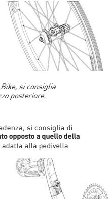
*Quando lo si utilizza su di una Mountain Bike, si consiglia di montare il sensore di velocità sul mozzo posteriore.*
