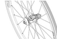
*En bicicletas de montaña se recomienda instalar el sensor de velocidad en el buje trasero.*
